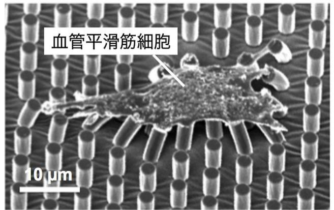
直径・高さが数 $\mu\text{m}$ の微小な柱を使って細胞が運動したり増殖したりするときの力を精密に計測している様子。
