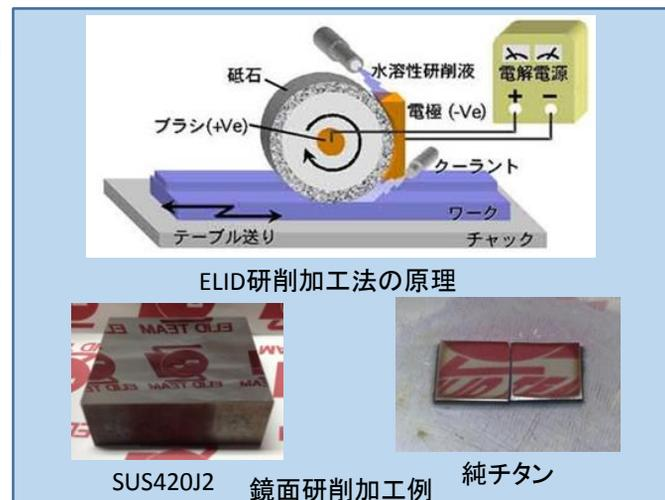
ELID(エリッド)は、超微細ダイヤモンド砥石によりPV1.65nmなどのナノレベル表面を達成する独自のメカニカル加工手法。エンジンの加工に使われてます。
