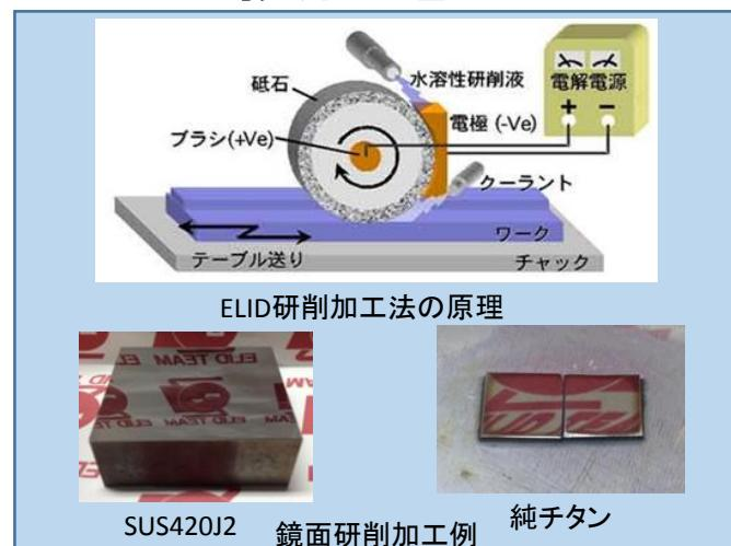
ELID(エリッド)は、超微細ダイヤモンド砥石によりPV1.65nmなどのナノレベル表面を達成する独自のメカニカル加工手法。エンジンの加工に使われています。
