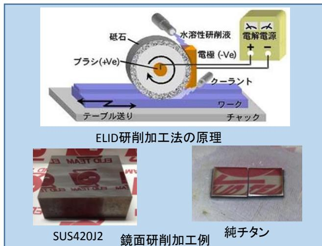
ELID(エリッド)は、超微細ダイヤモンド砥石によりPV1.65nmなどのナノレベル表面を達成する独自のメカニカル加工手法。エンジンの加工に使われてます。
